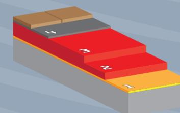
\*Avant la première couche, vérifier si sur le support il y a joints, ou des points plus délicats, comme des jonctions entre éléments horizontales et verticales; utiliser, donc, notre rabat élastique et la notre Membrana Gold, pour un traitement préliminaire; pour terminer étendre l'imperméabilisant.
